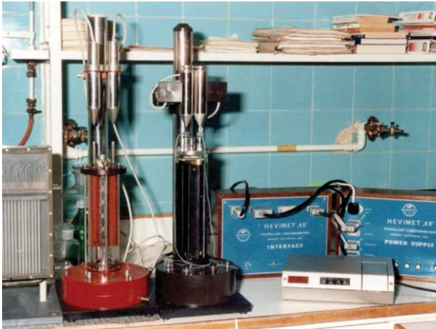
23. ábra. Kollár Lajos által konstruált viszkoziméter. Fig. 23. Viscosimeter designed by Lajos Kollár.
